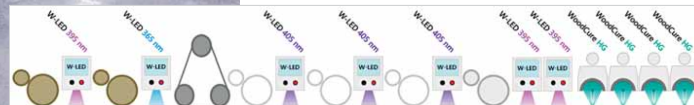
Die Beschichtungsline im schematischen Überblick macht die Anzahl der eingesetzten „W-LED“-Stationen deutlich. Sie unterscheiden je nach ihrem Einsatzort durch unterschiedliche Wellenlängen
