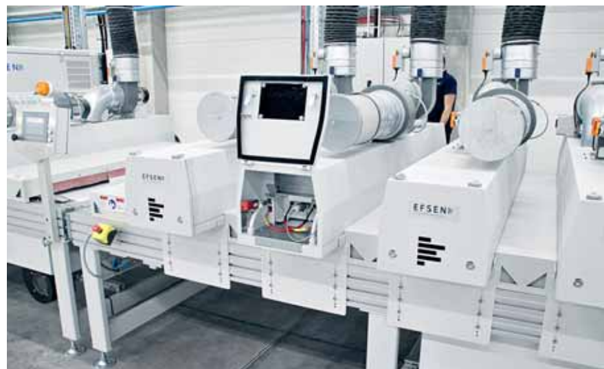
Links: „Wood Cure“, das konventionelle UV-Lampensystem von Efsen, verfügt über eine geführte Kühlung und eine überlegene Temperaturregelung. Rechts: Am Ende der Fertigungslinie sorgen nach dem Decklackauftrag zunächst zwei „W-LED“-Stationen und im Anschluss fünf „Wood Cure“-Einheiten für die finale Härtung der Oberflächen
