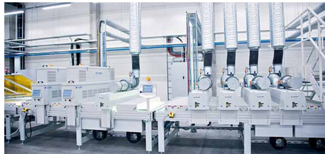
Links: „Wood Cure“, das konventionelle UV-Lampensystem von Efsen, verfügt über eine geführte Kühlung und eine überlegene Temperaturregelung. Rechts: Am Ende der Fertigungslinie sorgen nach dem Decklackauftrag zunächst zwei „W-LED“-Stationen und im Anschluss fünf „Wood Cure“-Einheiten für die finale Härtung der Oberflächen
