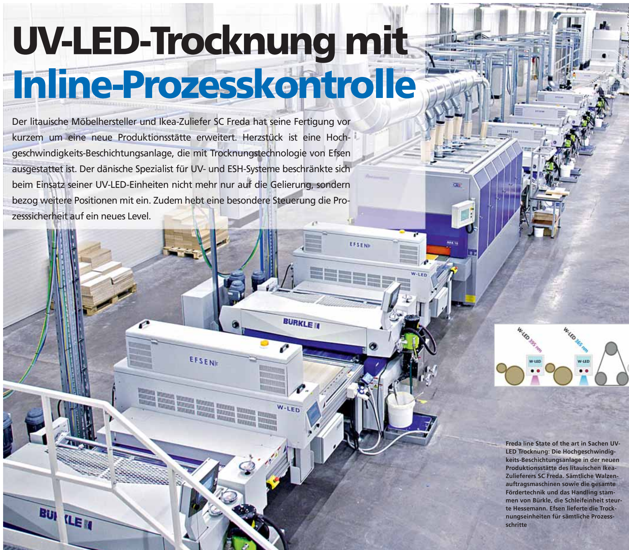
Die Beschichtungsline im schematischen Überblick macht die Anzahl der eingesetzten „W-LED“-Stationen deutlich. Sie unterscheiden je nach ihrem Einsatzort durch unterschiedliche Wellenlängen
