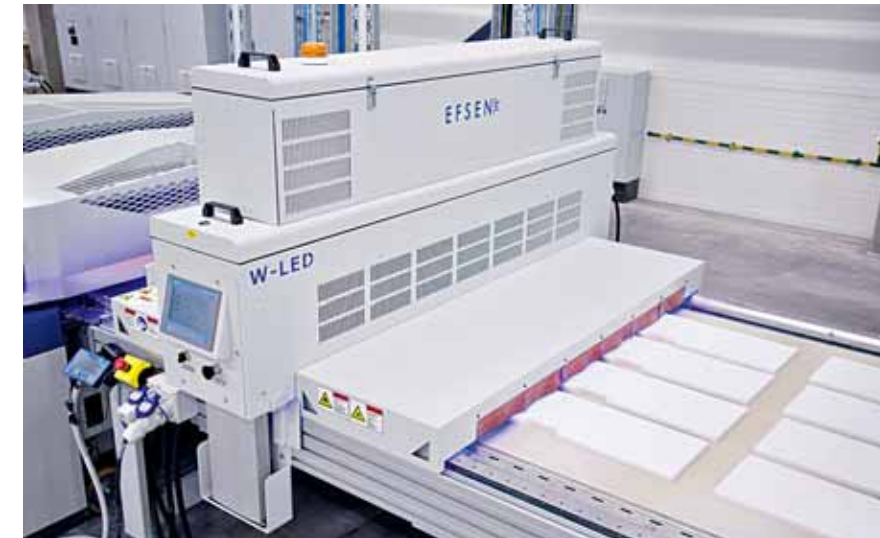
Die proprietäre „ICAD“-Inline-Prozesskontrolle ist integraler Bestandteil aller UV-LED-Produkte von Efsen. Die intelligente Inline-Steuerung misst kontinuierlich die UV-Leistungsabgabe der Lampe über die gesamte Anlagenbreite
